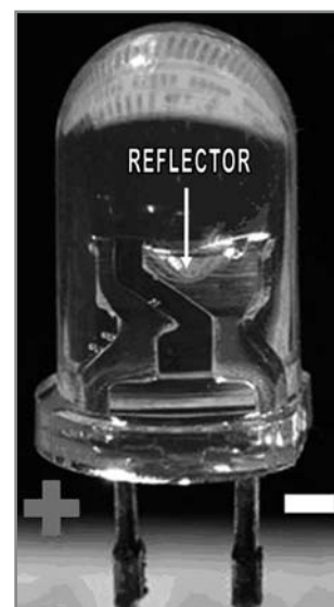
Foto 2. El reflector del LED también refleja la luz incidente.
